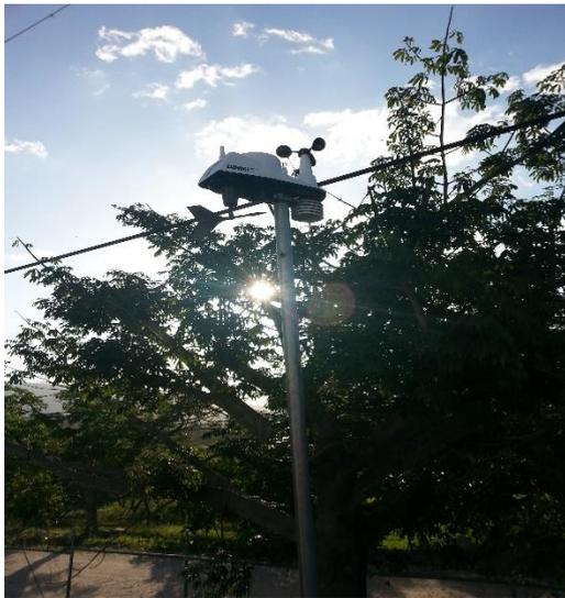
Figura 7. Anemómetro y dirección
