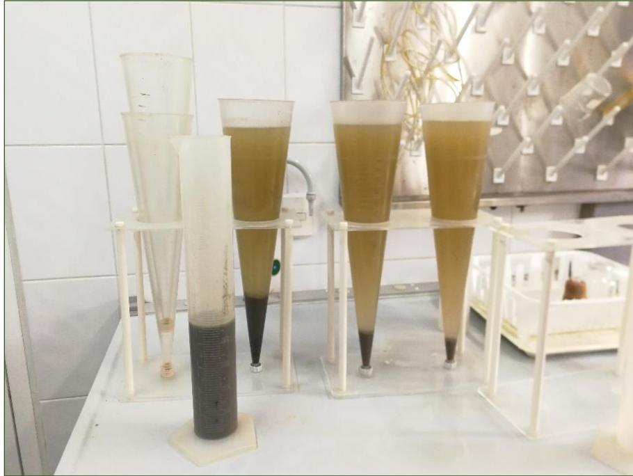
Anexo 5. Decantación de lodos primarios
