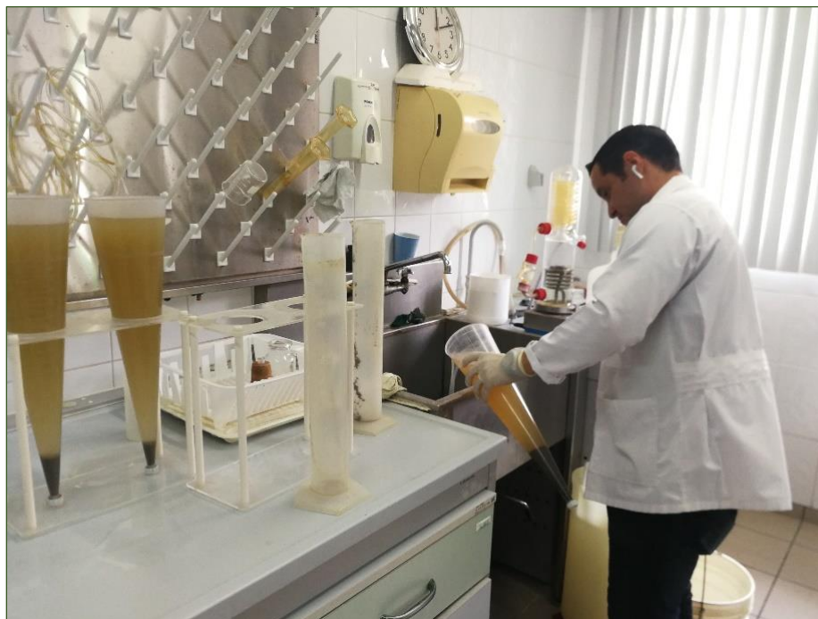
Anexo 6. Separación de SSV para ensayo de AME
