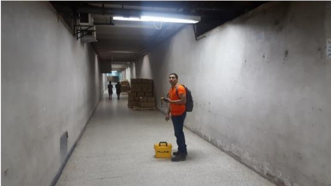
**Figura A 2 Toma de datos con luxómetro en pasillo de servicio. , 2017**
