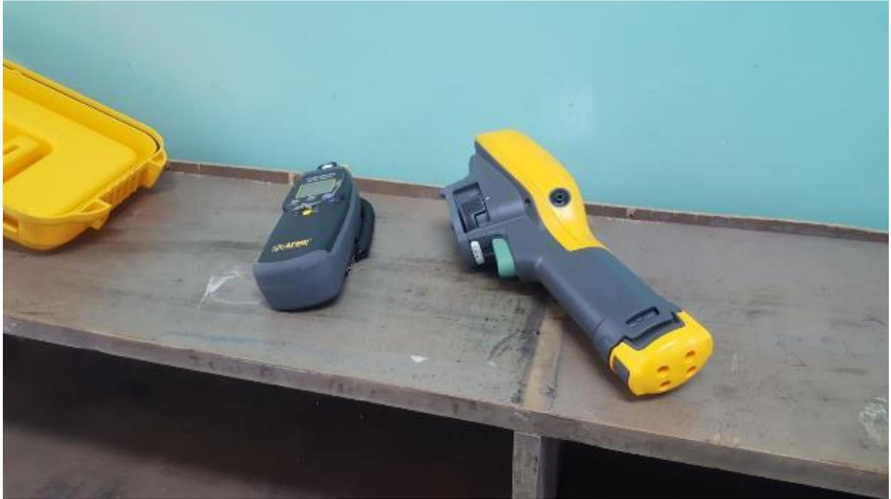
**Figura A 5 Cámara termográfica y luxómetro, 2017**
