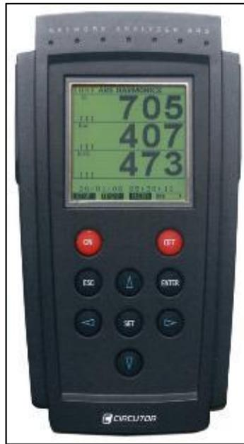
**Figura 11 Analizador de red AR5, marca CIRCUITOR**
