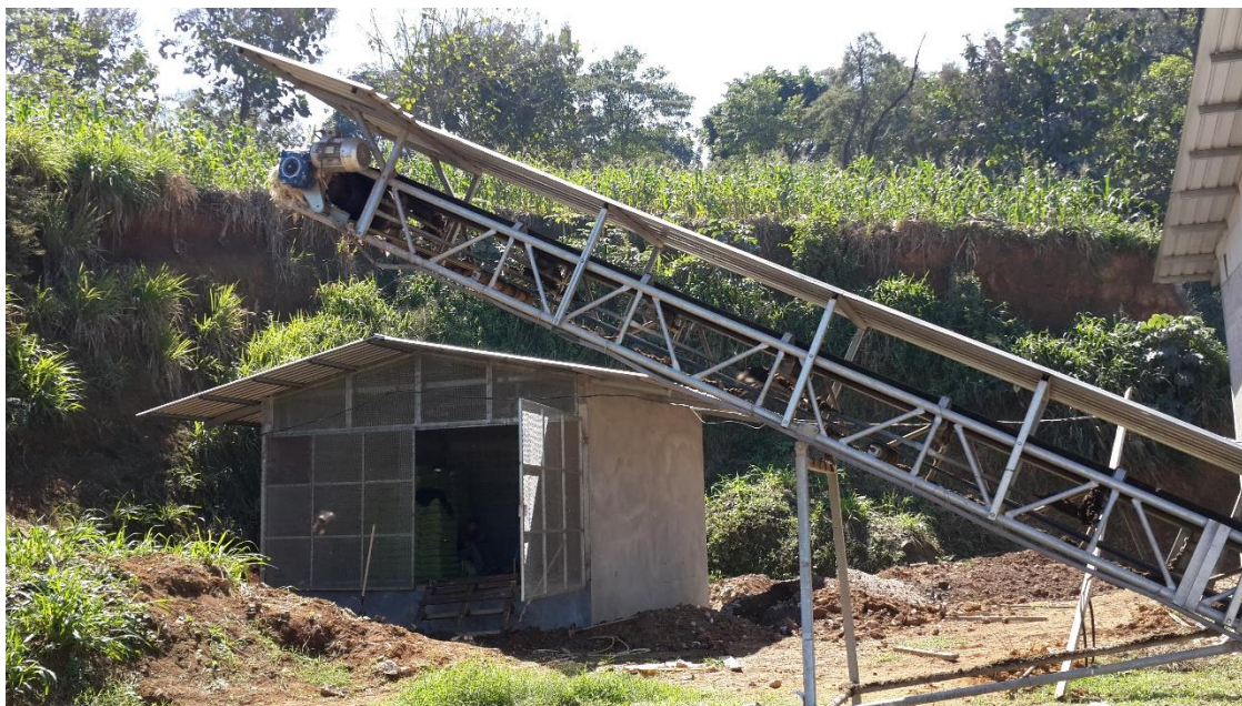
Figura 5. Sistema de recolección de gallinaza en galeras automáticas
