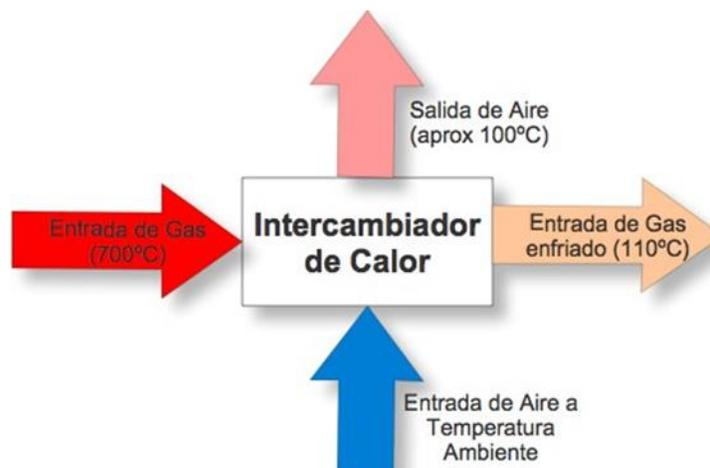
**Figura 33. Esquema de Enfriamiento**
