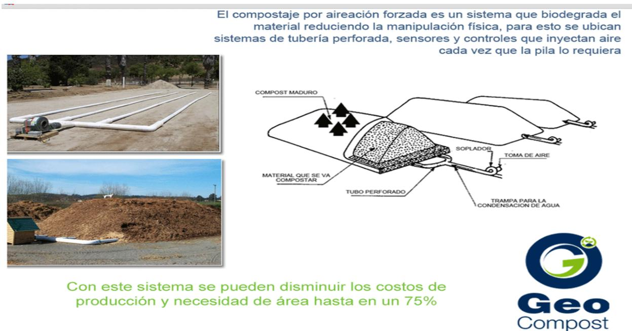
**Figura 27. Compostaje con aireación Forzada**
