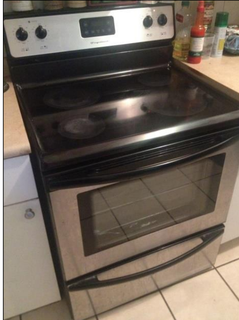
Figura 12. Estufa eléctrica de hornilla de punto rojo (grande y pequeño), con horno de doble resistencia
