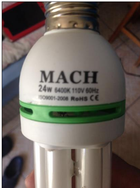
Figura 11. Foco fluorescente compacto instalado en las viviendas
