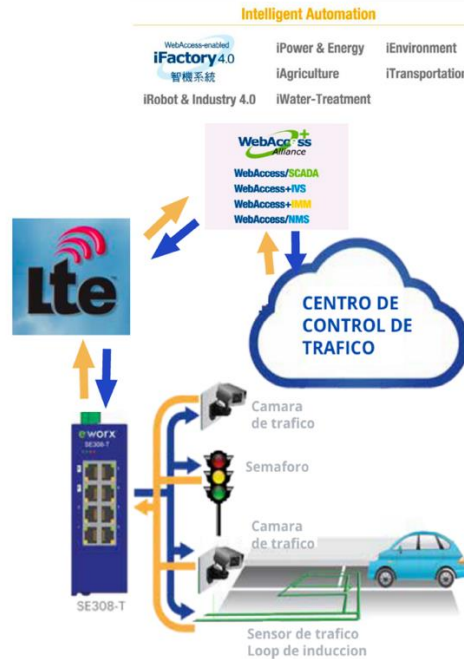
Figura 11. Operación del proyecto piloto.
