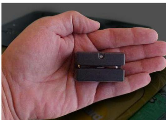
**Figura 1 skimmer aparato que se usa para clonar tarjetas de crédito**
