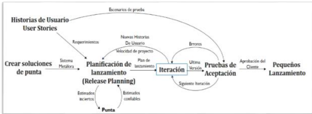
Figura 5. Diagrama Estructura de un proyecto de desarrollo de software con XP
