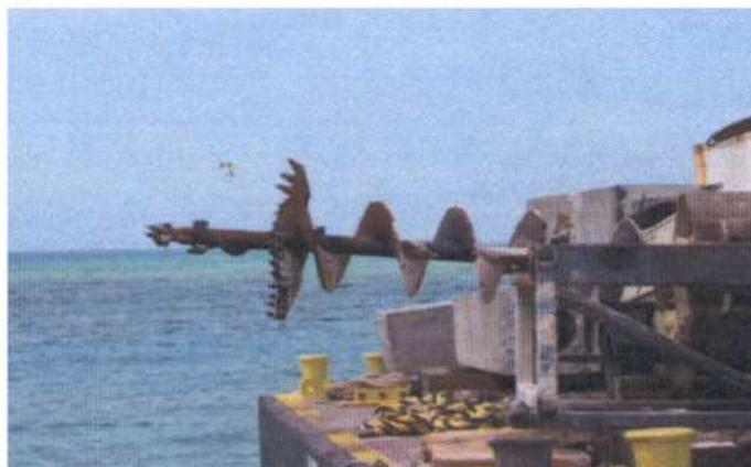
Figura 32. Ejemplo de taladro a utilizar para perforación de superficie marina.
