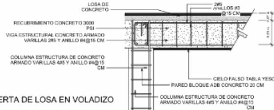
3 CUBIERTA DE LOSA EN VOLADIZO
