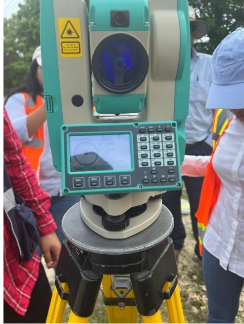
Ilustración 24-Colocacion del láser de la Estación Total
