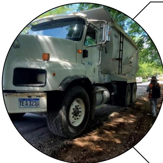
La prueba de carga con volqueta es realizada para evaluar la capacidad de carga y la estabilidad la subbase de la carretera Siguatepeque - Jesús de Otoro, para llevar a cabo la prueba es necesario preparar el lugar, cargar la volqueta para posteriormente colocarlo en la zona que se desea estudiar, de manera que permita registrar las deformaciones y finalmente analizar los datos obtenidos.
