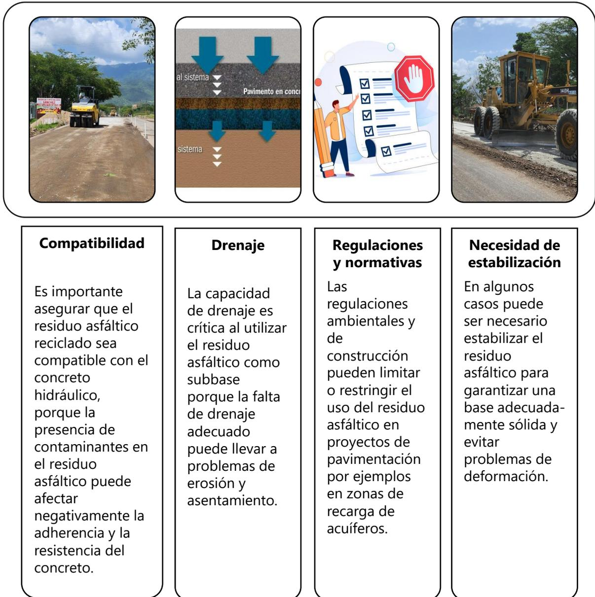
**Gráfico 22 Desventajas al utilizar residuo asfáltico como subbase para un concreto.**
