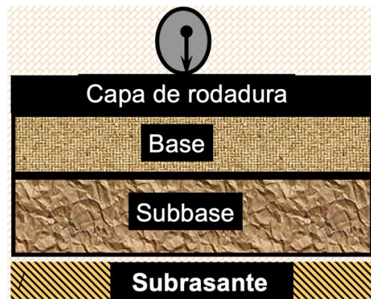
Ilustración 24 Base y subbase
