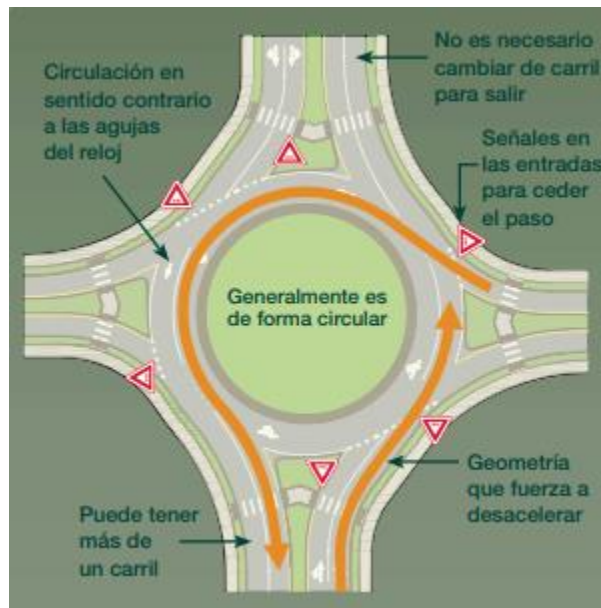
Ilustración 1. Características de una rotonda
