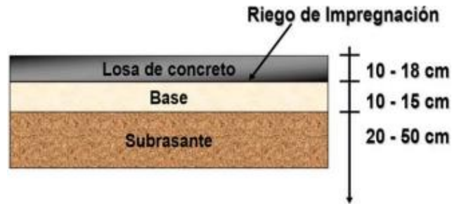
Ilustración 17. Corte transversal de pavimento rígido
