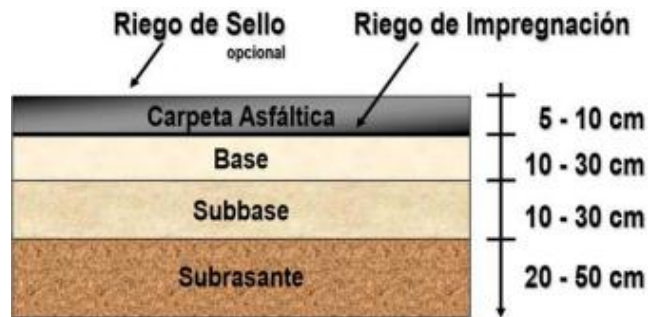
Ilustración 18. Corte transversal pavimento flexible
