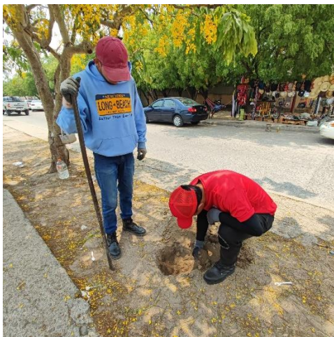
Ilustración 38. Extracción de la muestra del suelo
