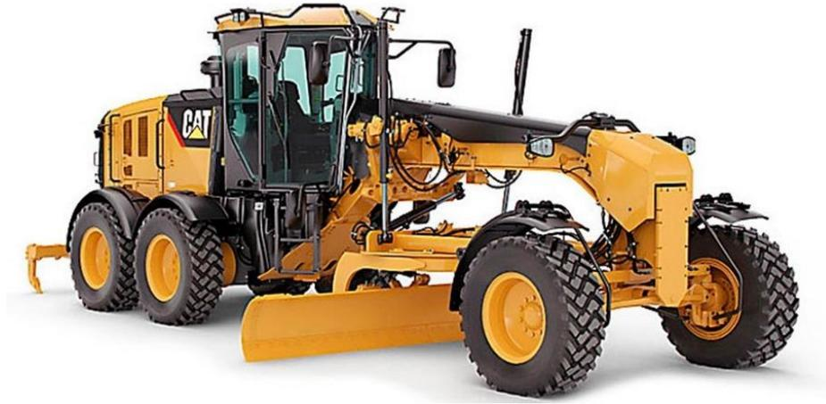
**Ilustración 26. Motoniveladora**
