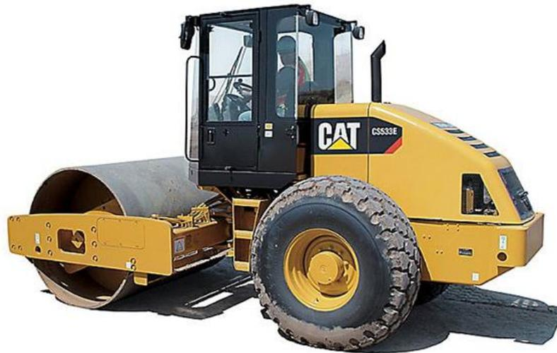
**Ilustración 27. Compactadora de rodillo vibratorio**
