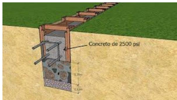
**Ilustración 34. Ejemplo de viga tensora**
