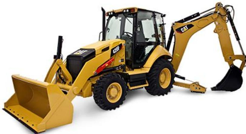
**Ilustración 24. Retroexcavadora**
