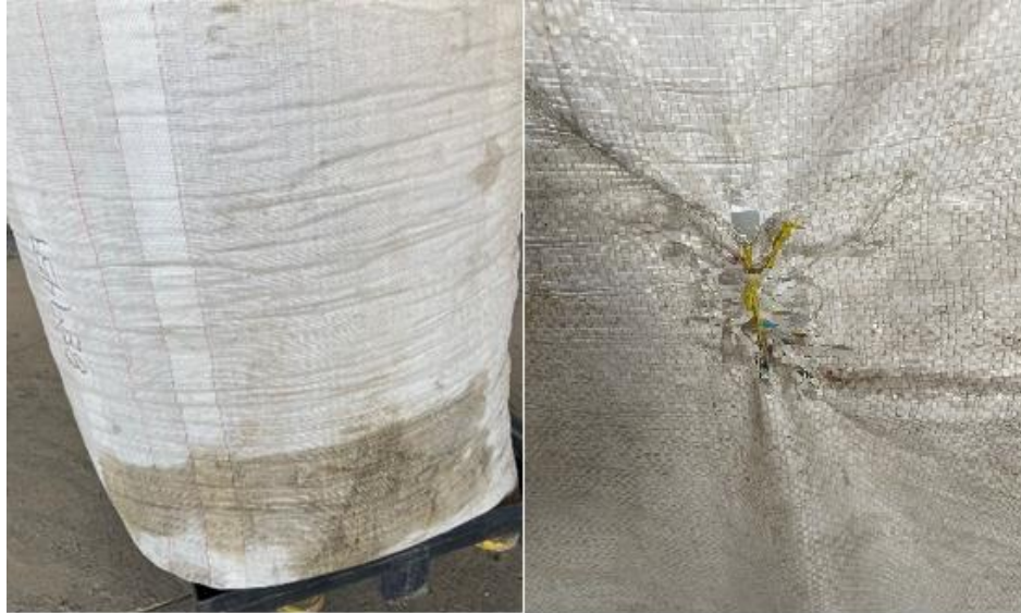
Figura 4.1: Super saco de empaque con humedad y rotura
