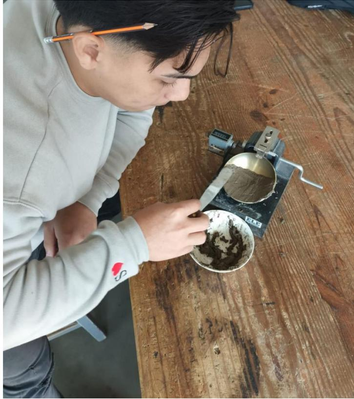
**Ilustración 136- Ensayo de Límites de Atterberg**
