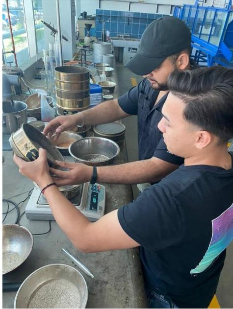
**Ilustración 134- Ensayo granulométrico**
