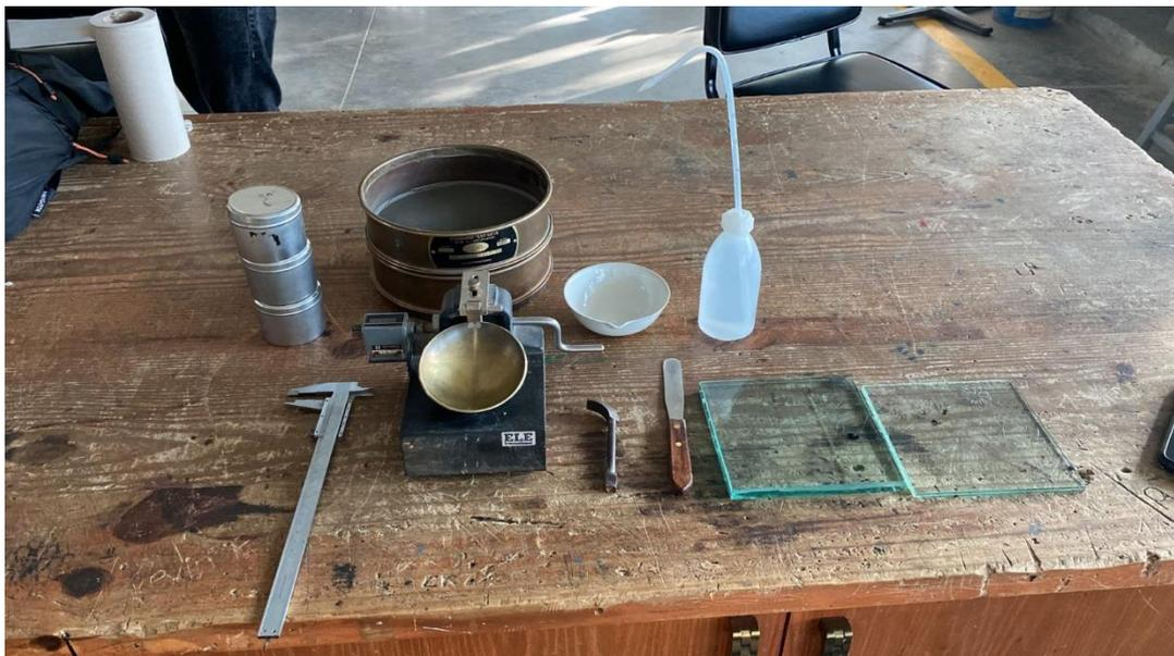
**Ilustración 135- Ensayo de Limites de Atterberg**
