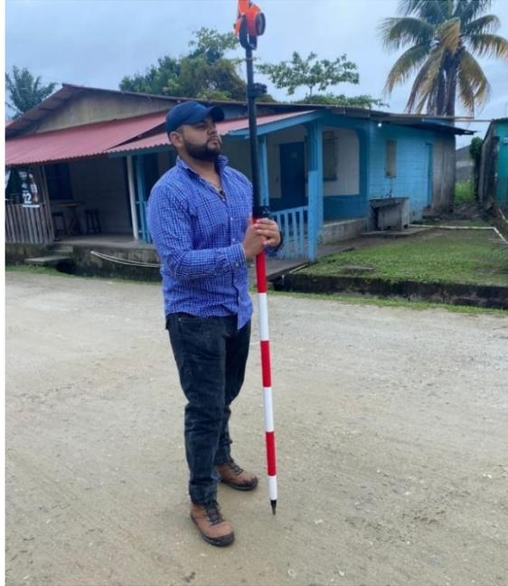
**Ilustración 132- Levantamiento topográfico mediante bastón y prisma**
