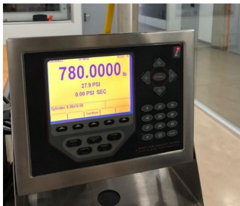
Ilustración 30 Carga sometida a la probeta de suelo
