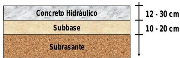
Ilustración 9 Pavimento concreto hidráulico
