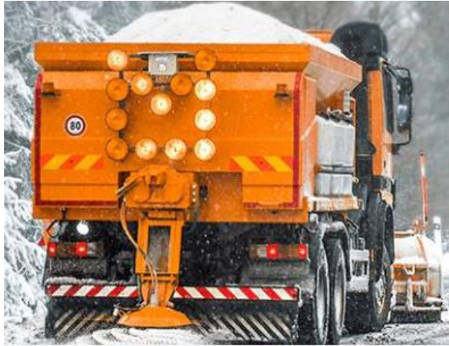
Ilustración 48 Estabilización con cloruro de sodio en nieve
