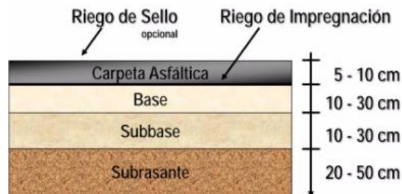
Ilustración 8 Pavimento sección transversal asfáltico (flexible)
