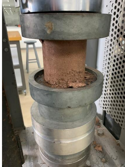
Ilustración 29 Ensayo a compresión por medio de cilindros elaborados de suelo
