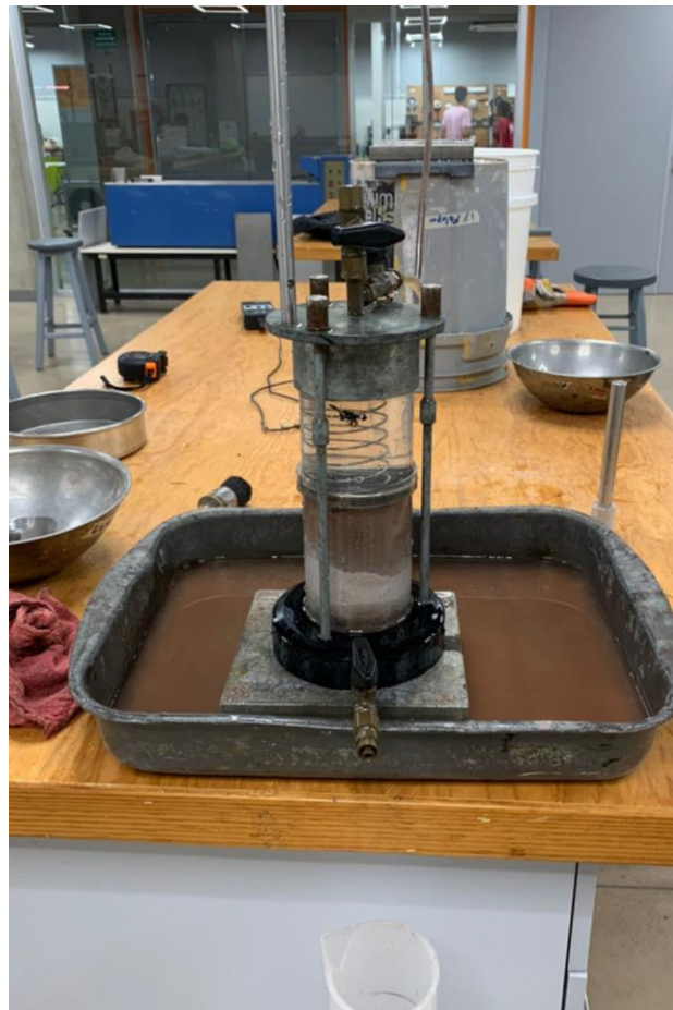
Ilustración 64 Permeabilidad con suelo cemento 16%
