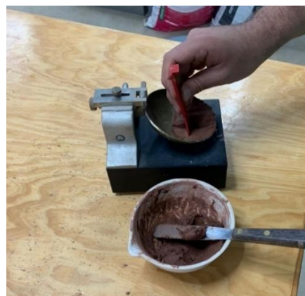
Ilustración 57 Ensayo de Casagrande para límite líquido de la muestra
