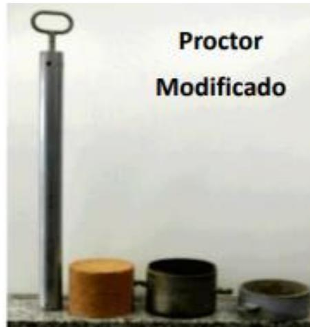
**Ilustración 22 Ensayo de Proctor modificado**
