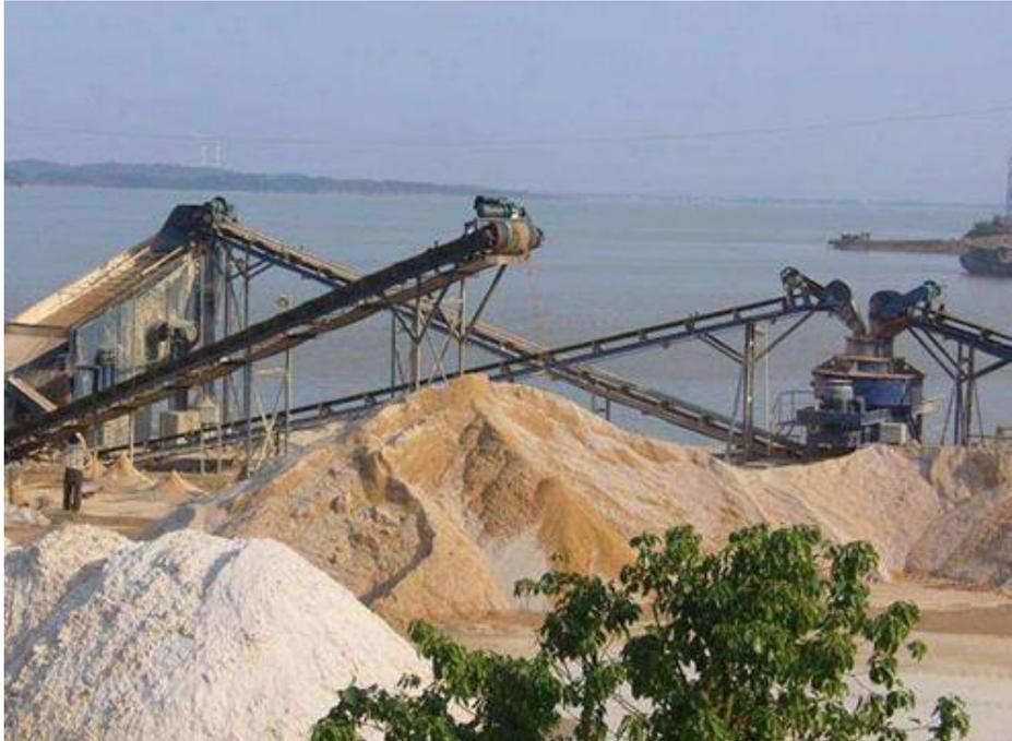
**Ilustración 18 Planta trituradora de agregados**
