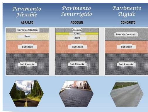
**Ilustración 6 Tipos de pavimentos**
