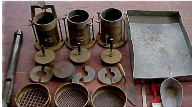
**Ilustración 24 Ensayo CBR**
