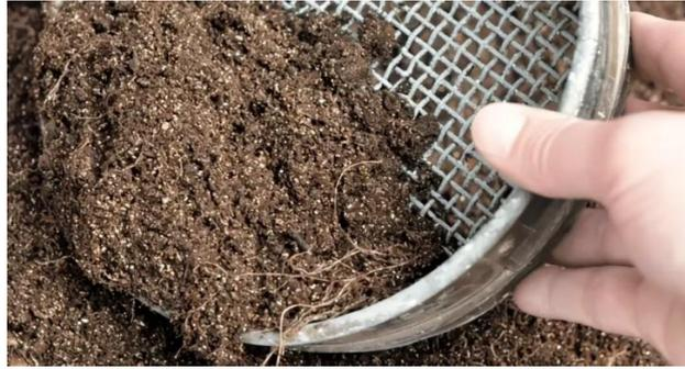
**Ilustración 21 Ensayo Granulométrico**
