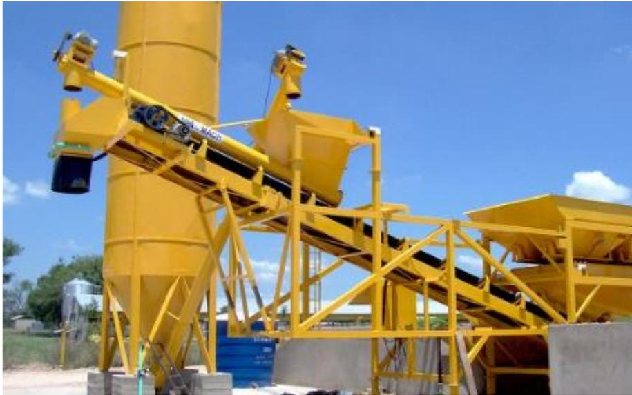
**Ilustración 19 Planta dosificadora de concreto**
