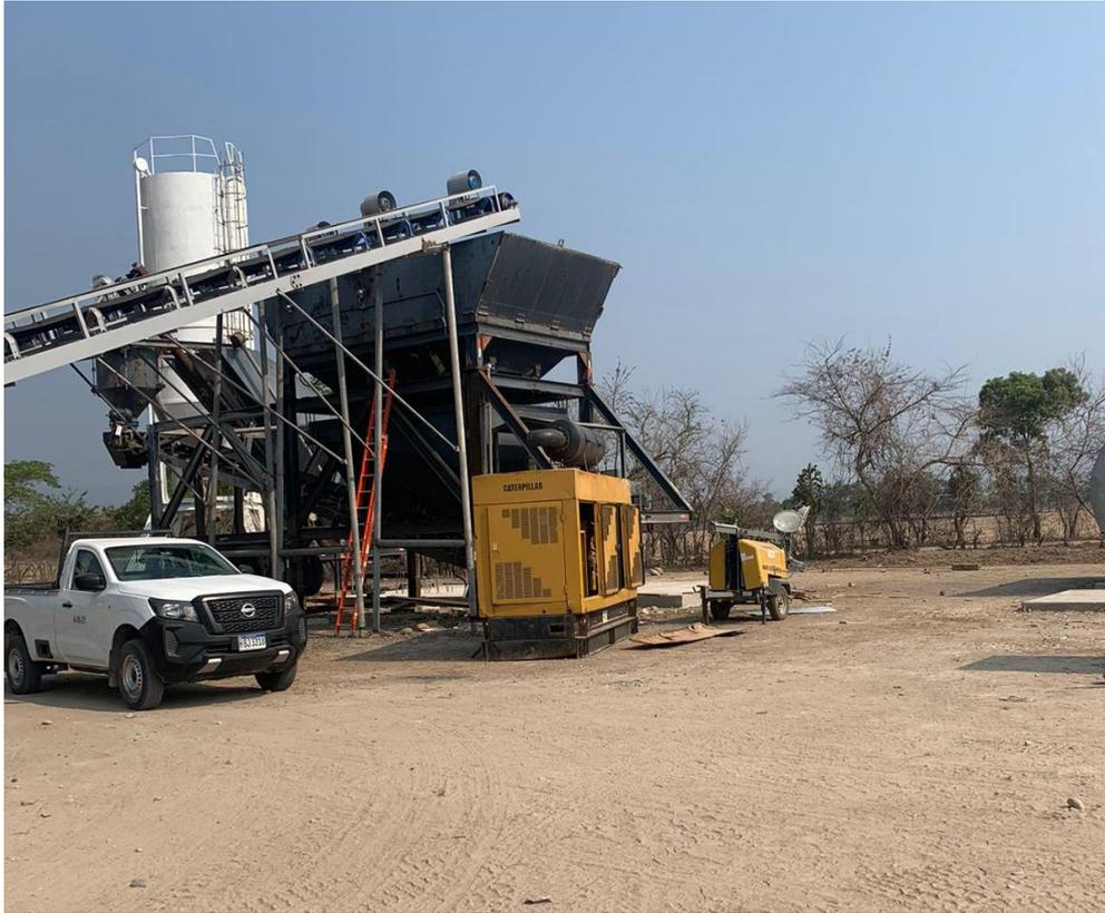
**Ilustración 29 Planta dosificadora de concreto**
