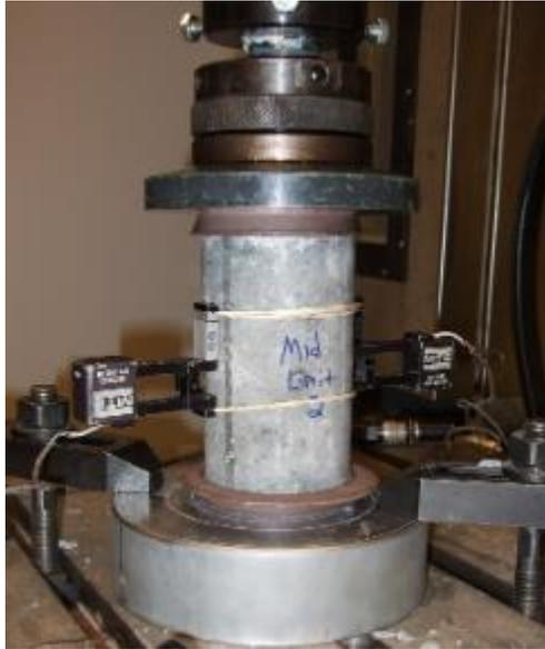
**Ilustración 26 Ensayo a compresión axial**
