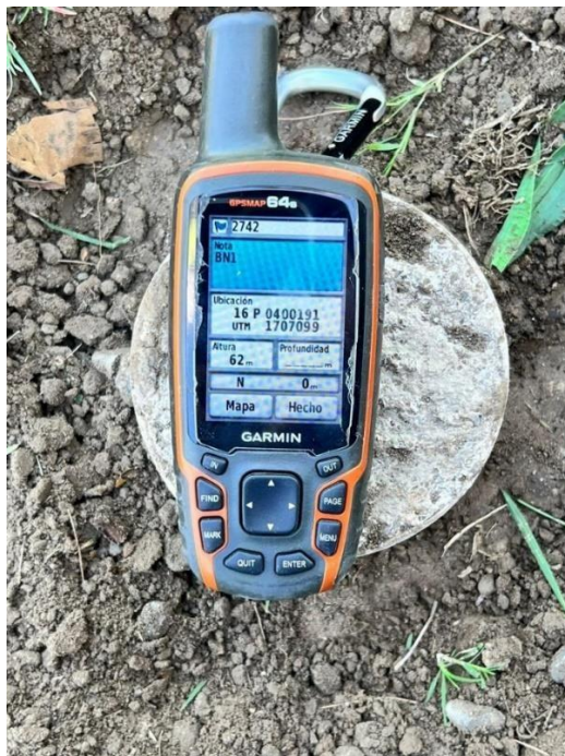
Ilustración 130- Estableciendo el BN 1 en el levantamiento topográfico
