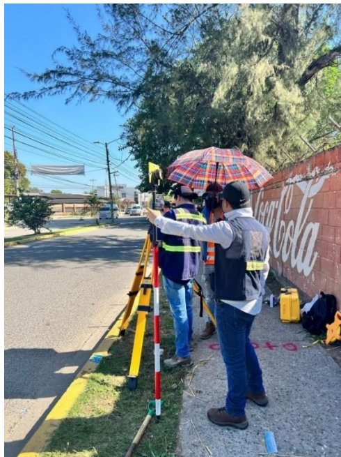
Ilustración 129- Calibración del equipo previo a realizar el levantamiento topográfico
