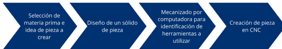
Ilustración 41 Proceso ideal de manufactura de piezas utilizando CNC
