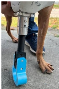
Ilustración 36. Prototipo final del canino.
