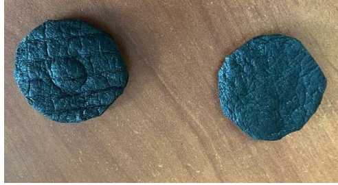
Ilustración 31. Círculos de foamy para el sistema de amortiguamiento de impacto.
