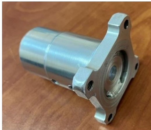
Ilustración 26. Acople para prótesis.
