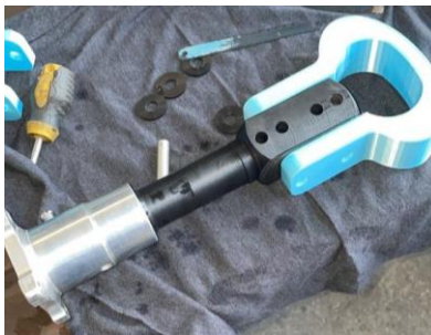
Ilustración 35. Ensamblaje del acople, amortiguador y base.
