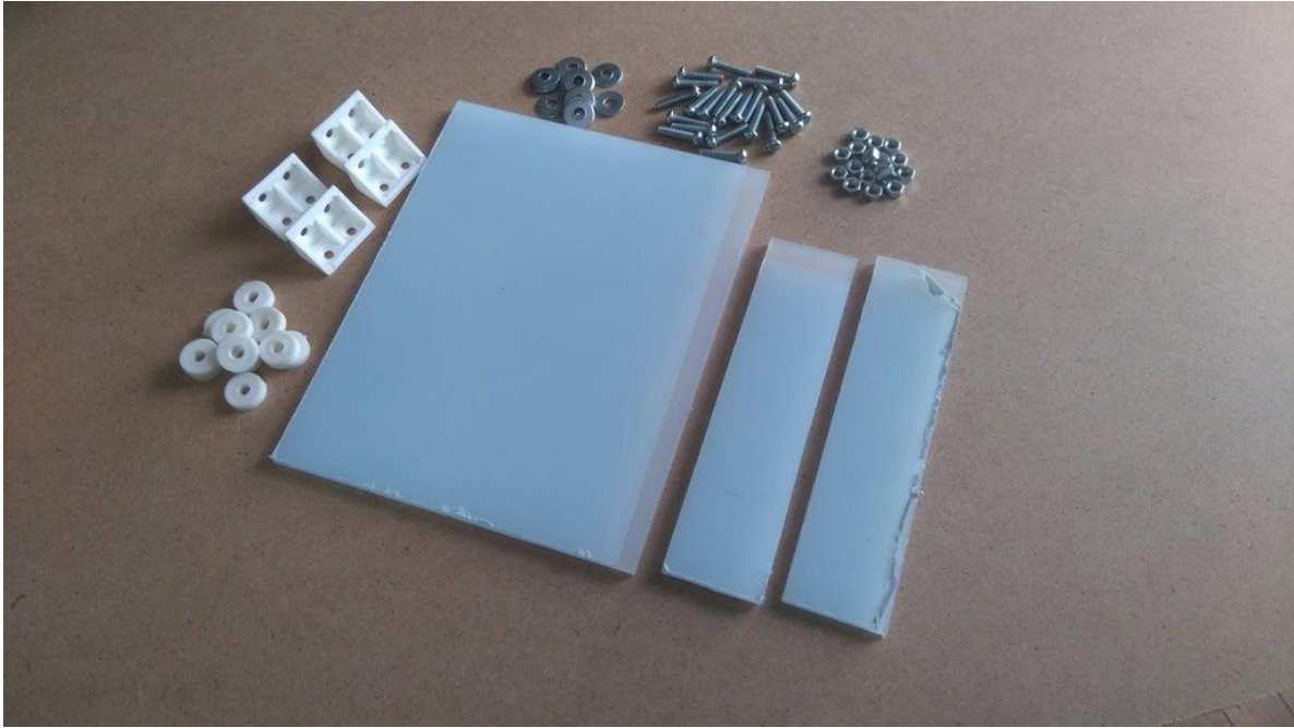
Figura 4. 21 Tablas de Plexiglás, Tuercas, Tornillos, Espaciadores.
