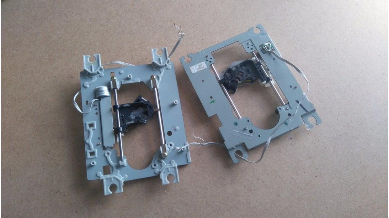
Figura 4. 25 Dvd's desmontados para motores paso a paso.
