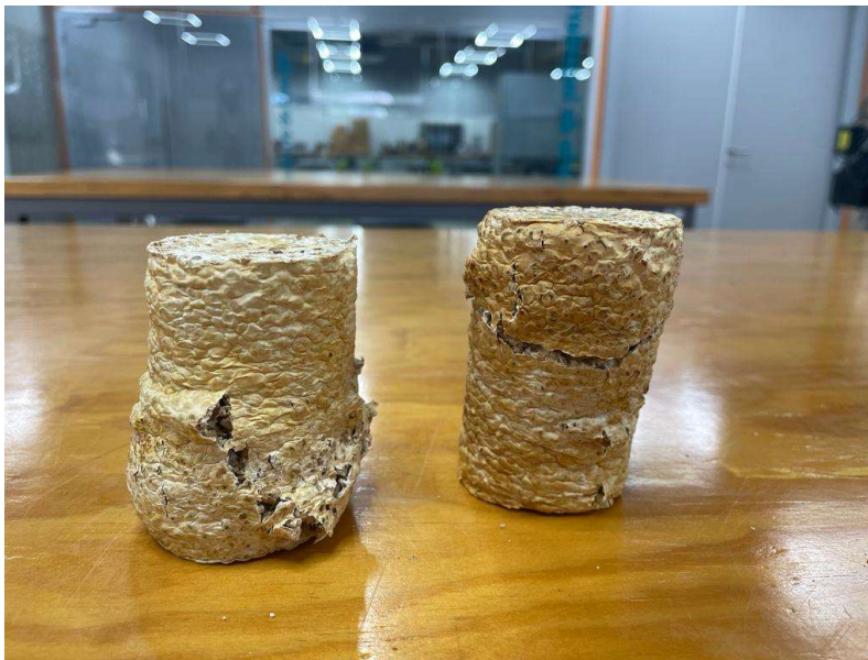
Ilustración 59 Falla en probetas de micelio
