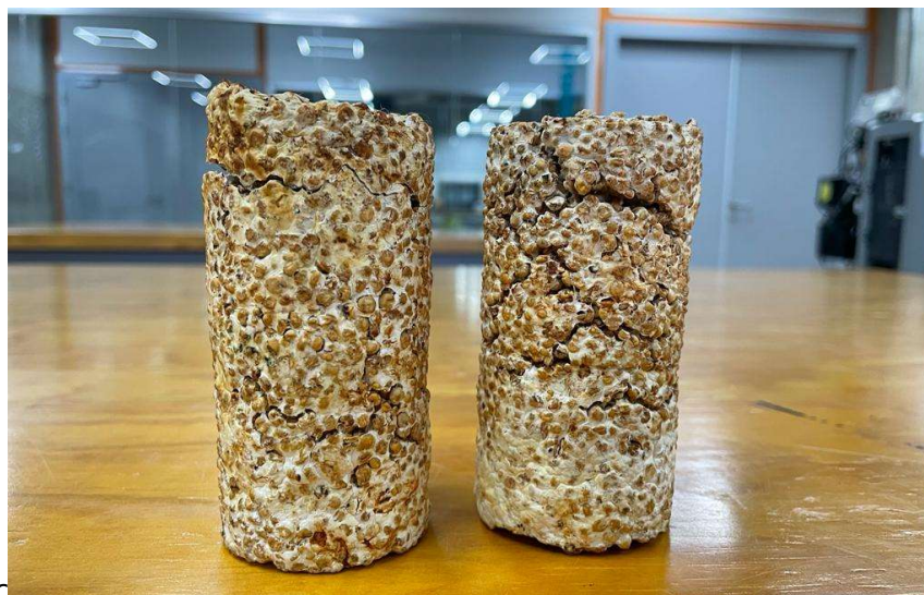
Ilustración 64 Micelio de Pleurotus Ostreatus secado durante 2 horas a 110 °C
