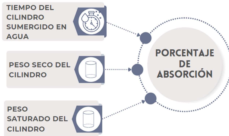
Ilustración 23 Variables de investigación de ensayo de absorción
