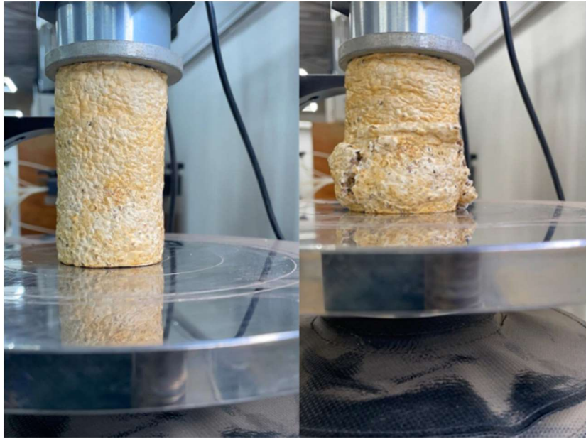
Ilustración 58 Deformación de micelio
