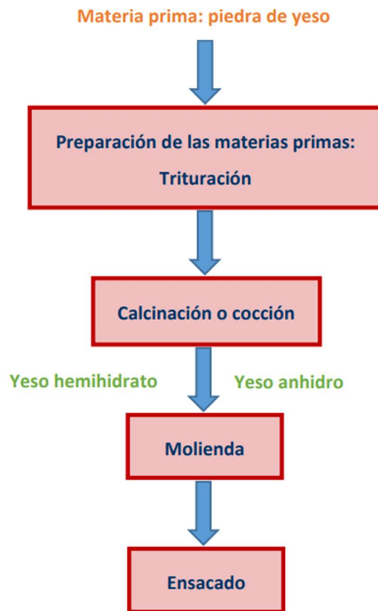
Ilustración 15 Diagrama de flujo del procesamiento del yeso
