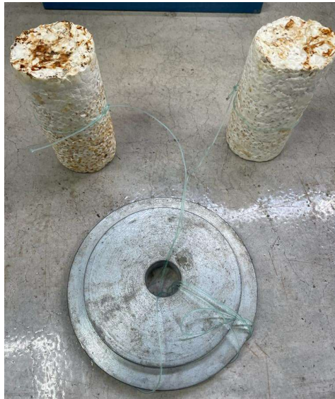
Ilustración 60 Amarre de cilindros a peso metálico
