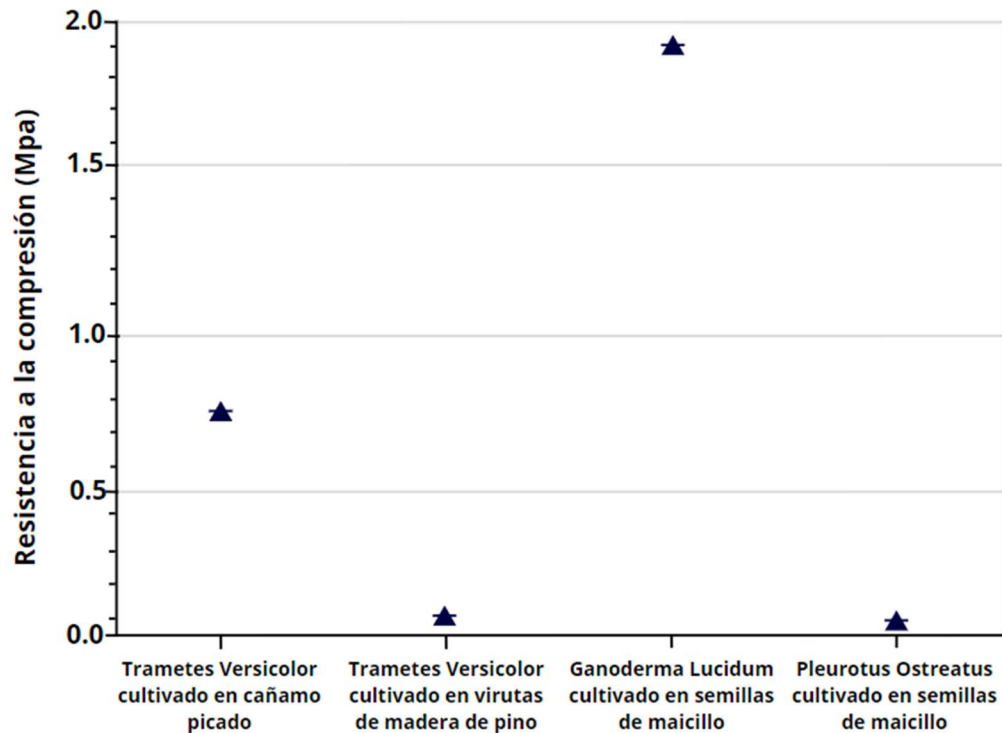
Gráfica 5 Resistencia a la compresión de diferentes especies de micelio
