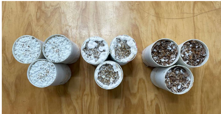
Ilustración 50 Moldes cilíndricos de micelio después de 5 días de crecimiento
