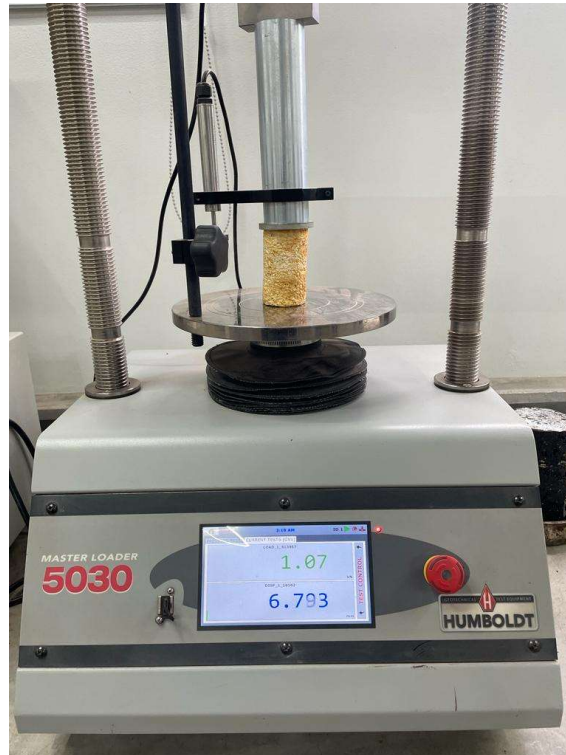
Ilustración 57 Colocación de probeta de micelio en máquina de compresión de laboratorio
