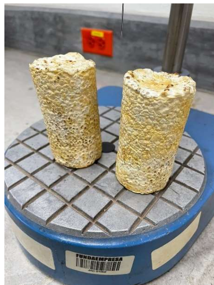
Ilustración 56 Micelio de Ganoderma Lucidum después de 3 meses de secado
