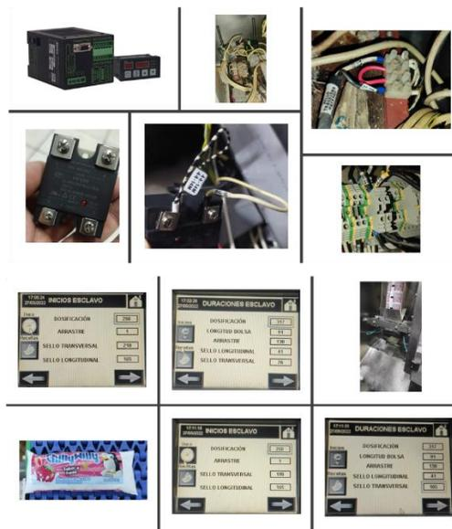
**Ilustración 16 Sustitución de controlador de temperatura**
