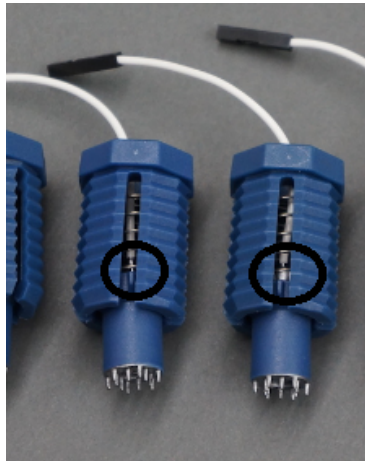
Ilustración 56 – Cable desplegable por uso excesivo
