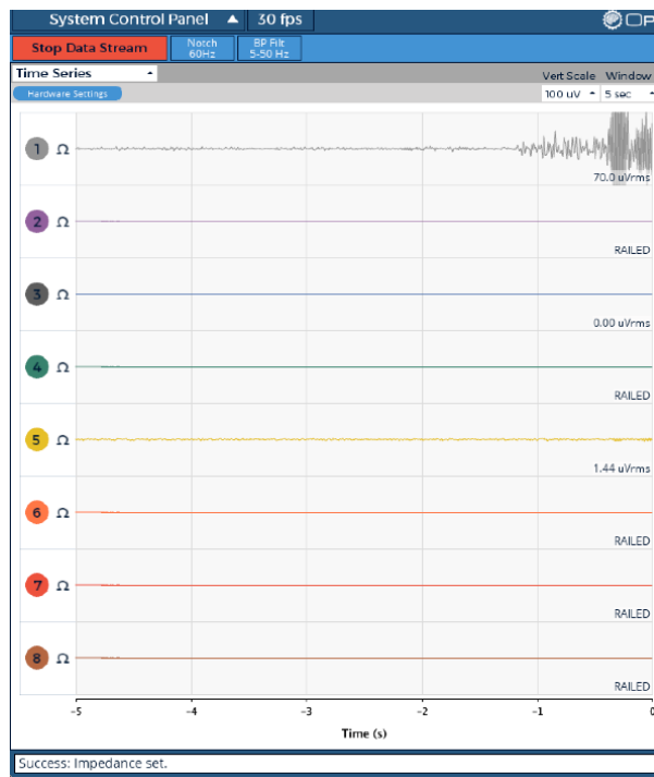
Ilustración 53 – Error de lectura de los electrodos
