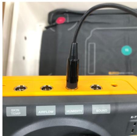
**Ilustración 25. Conexión de la sonda de humedad**
