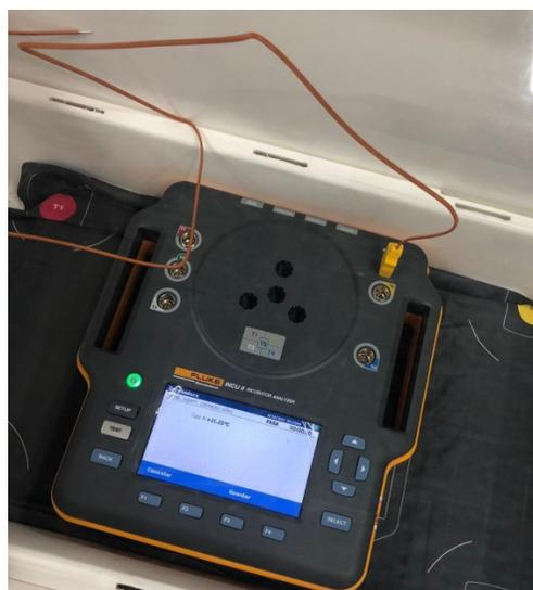
**Ilustración 36. Medición de la temperatura de la pared de la incubadora**
