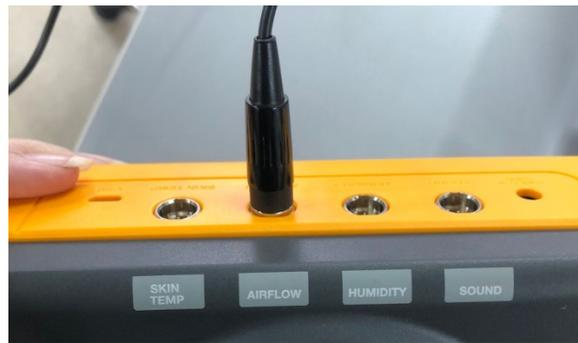
**Ilustración 28. Conexión de la sonda de flujo de aire**
