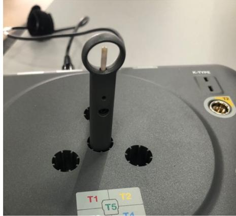
**Ilustración 27. Sonda de flujo de aire**
