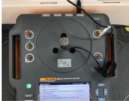
**Ilustración 12. Ubicación de la sonda en el analizador**
