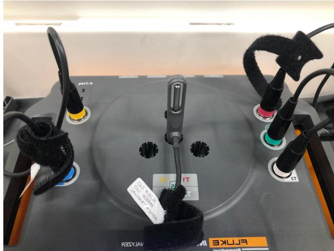
**Ilustración 5. Sonda de temperatura**
