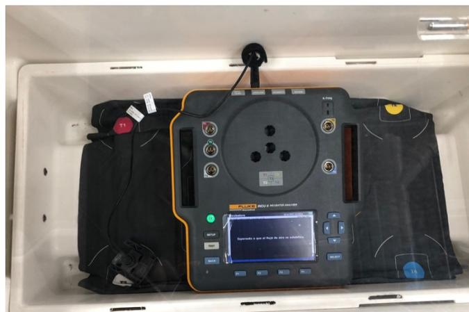
**Ilustración 29. Analizador realizando la medición en el cuadrante T3**
