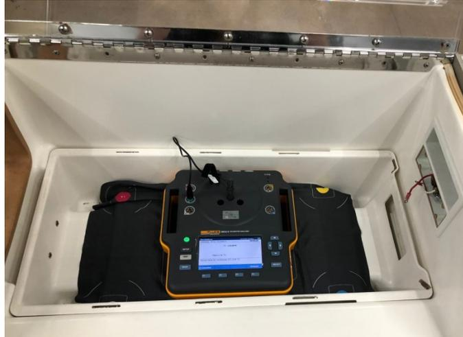
**Ilustración 31. Ubicación del analizador para la prueba de sobrecalentamiento de la incubadora**
