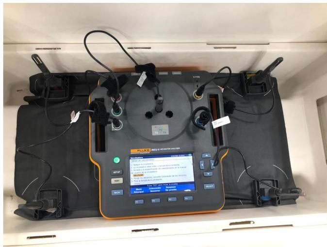
**Ilustración 6. Ubicación de las sondas de temperatura y analizador dentro de la incubadora para la prueba de tiempo de calentamiento**
