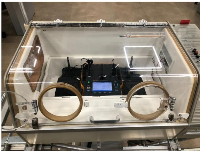
**Ilustración 23. Analizador realizando medición de la uniformidad de la temperatura**
