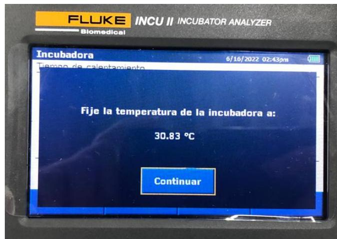
**Ilustración 8. Indicación de la temperatura a la que debe fijarse la incubadora**
