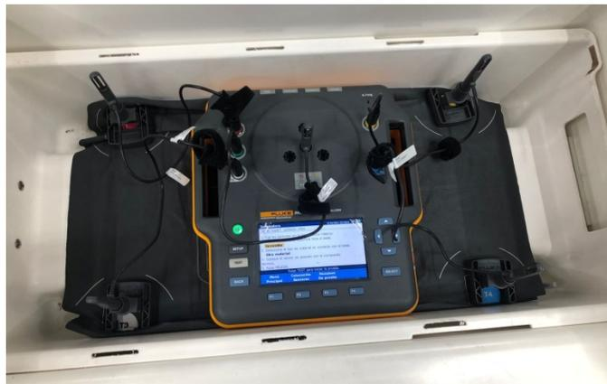
**Ilustración 22. Sondas de temperatura en su respectiva ubicación**
