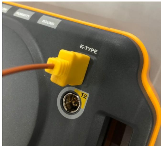
**Ilustración 33. Conexión del termopar**
