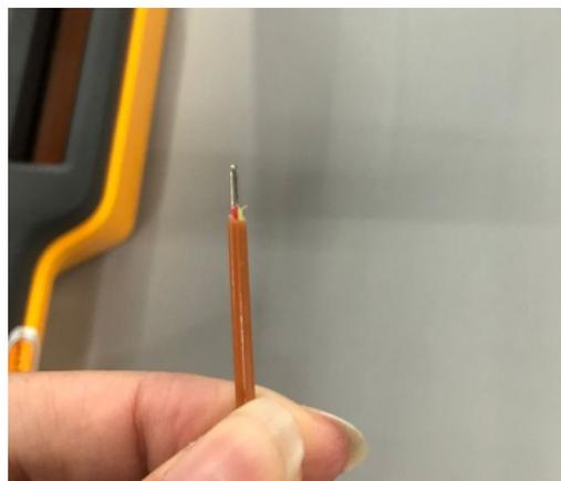
**Ilustración 32. Termopar tipo K**
