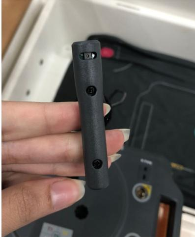
**Ilustración 24. Sonda de humedad**
