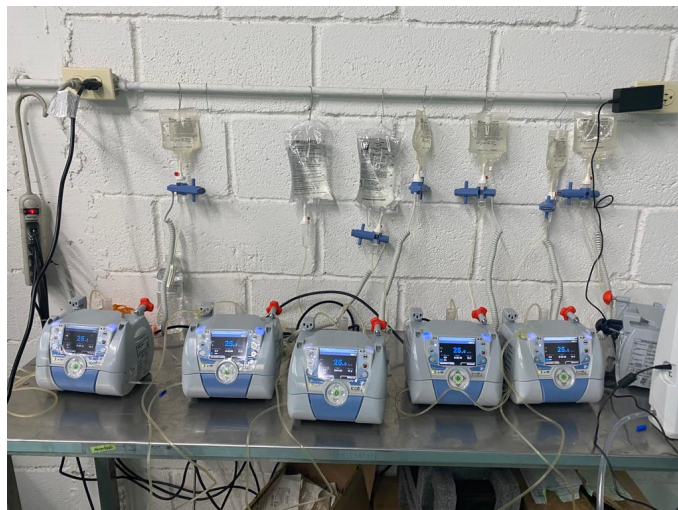
Ilustración 25 Prueba de control de calidad a bombas de infusión Icatus 3ED
