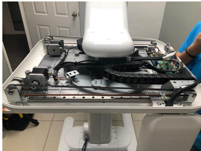
Ilustración 23. Reemplazo de tarjetas, bandas y motores del cefalométrico.
