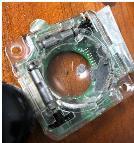
Ilustración 20. Trackball obstruido por acumulaciones de residuos y suciedad.
