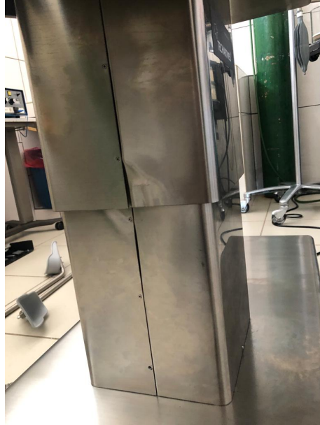
Ilustración 9. Deformación de tapadera de mesa ginecológica por traslape realizando pruebas de funcionamiento del equipo.
