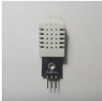
**Ilustración 10. Sensor DHT22**
