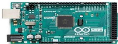
**Ilustración 9. Arduino Mega 2560**
