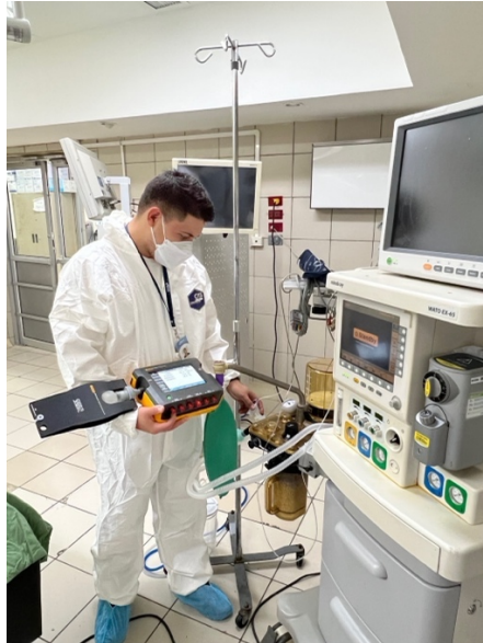
Ilustración 14: Mantenimiento Preventivo a Máquina de Anestesia
