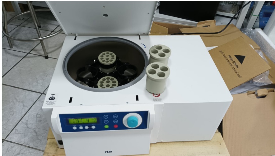
Ilustración 30: Máquina Centrífuga refrigerada instalada en Demedica
