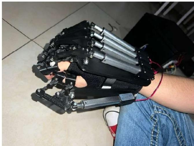
**Ilustración 74. Prototipo final flexionado.**
