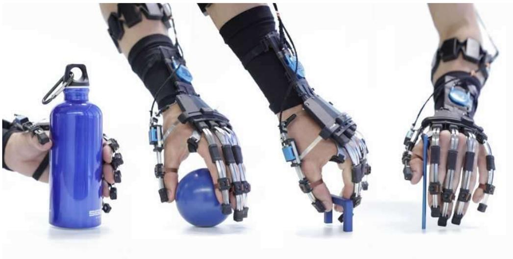
**Ilustración 1. Exoesqueleto ReLab tenoexo.**
