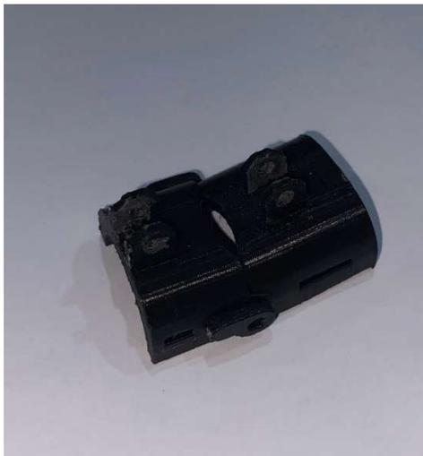
**Ilustración 68. Ensamble partes falange media y proximal.**
