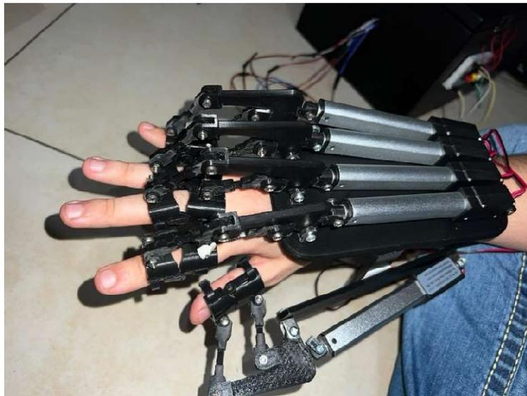
**Ilustración 72. Montaje prototipo.**
