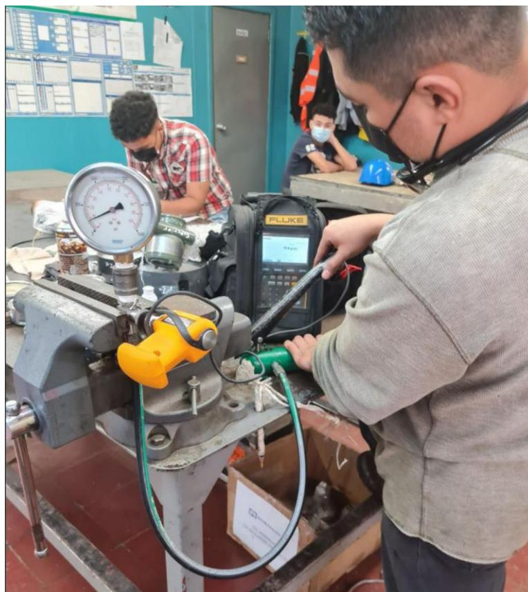
**Ilustración 9. Calibración manómetro alta presión**
