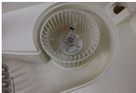
Ilustración 32 Jeringa encontrada en el interior de una incubadora.
