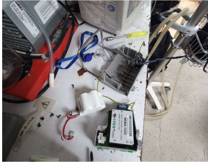
Ilustración 44 Centro de carga y batería de una bomba de Infusión. Fuente: Propia (2022).
