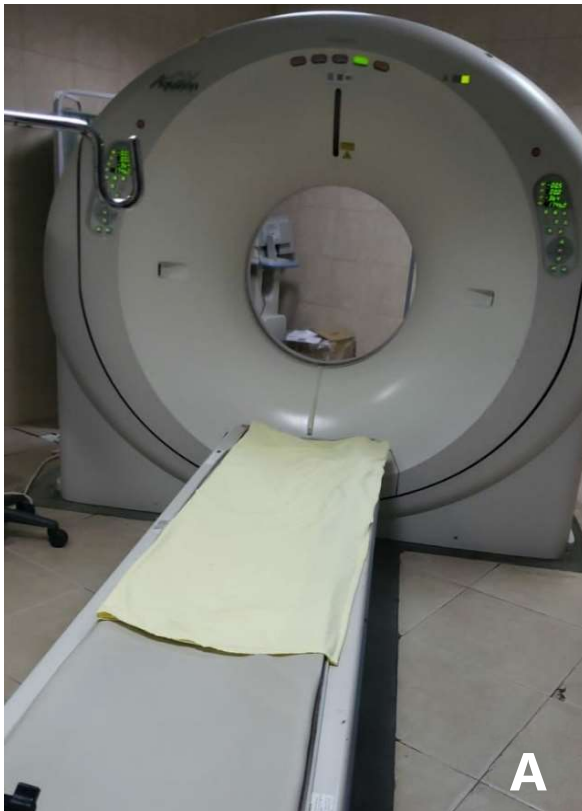
Ilustración 18 (A) Tomógrafo, (B) Estudio realizado con fantoma de prueba.
