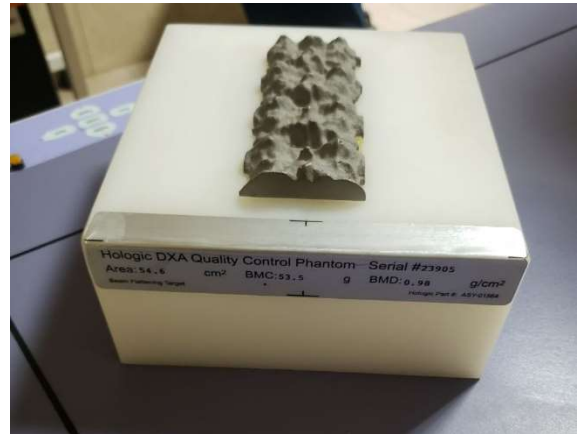
Ilustración 13 Equipo de densitometría y fantoma de prueba.
