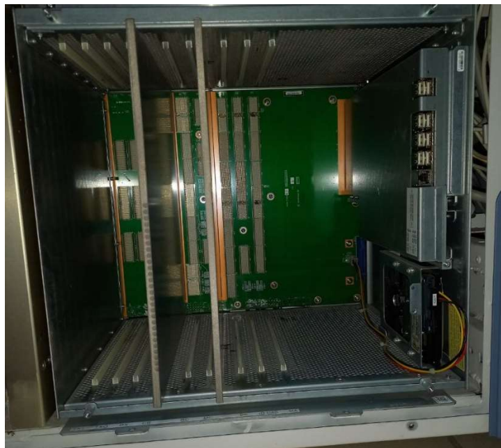
Ilustración 47 Ranuras de las tarjetas de un equipo de Ultrasonido.
