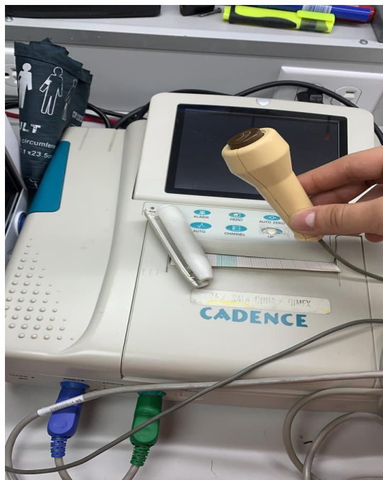
Ilustración 7. Reemplazo de botón en monitor fetal
