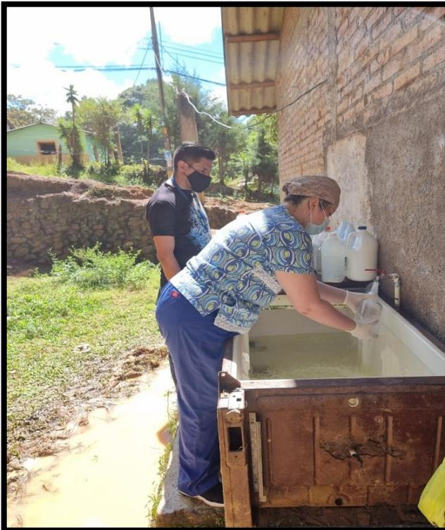
**Foto No. 4:** Recolección de la muestra de agua mediante botes estériles, en la junta de agua de el tablón.
