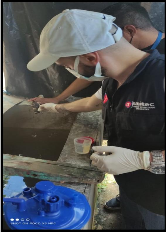
**Foto No. 13:** proceso de esterilización de la fuente de agua para la correcta toma de muestra
