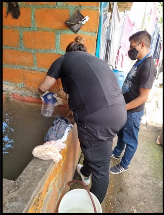
**Foto No. 10:** Recolección de la muestra de agua mediante botes estériles, en la junta de agua liquidámbar.
