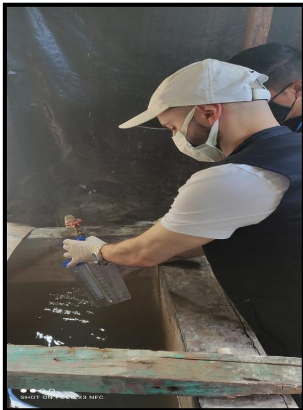
**Foto No. 14:** Recolección de la muestra de agua mediante botes estériles, en la junta de agua el Molino.
