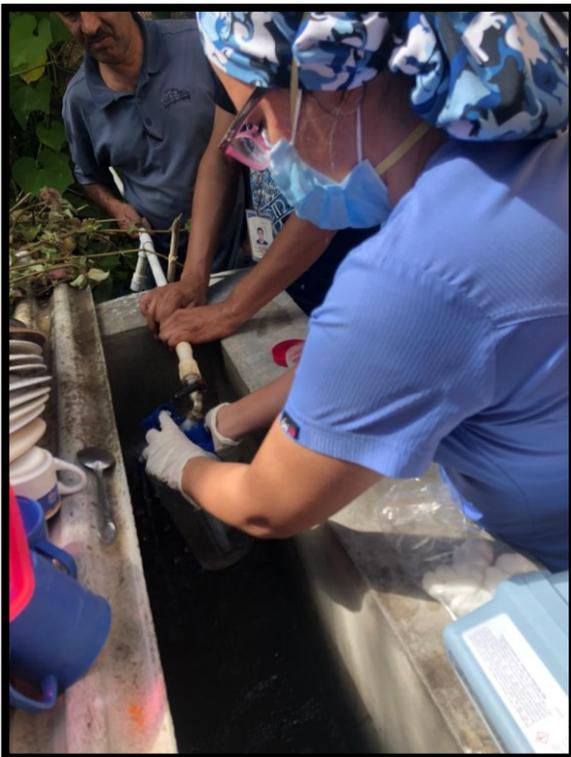
**Foto No. 12:** Recolección de la muestra de agua mediante botes estériles, en la junta de agua el Molino.
