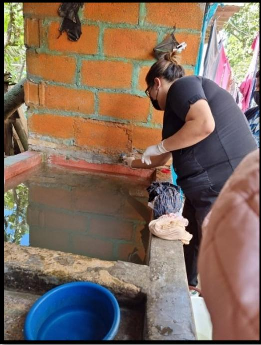
**Foto No. 9:** proceso de esterilización de la fuente de agua para la correcta toma de muestra
