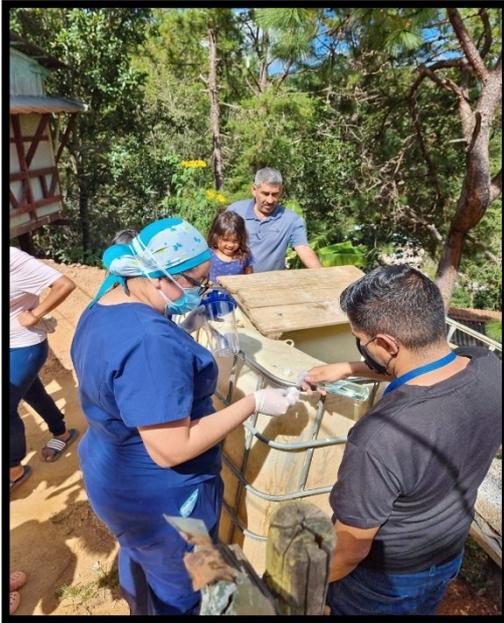
**Foto No. 1:** proceso de esterilización de la fuente de agua para la correcta toma de muestra
