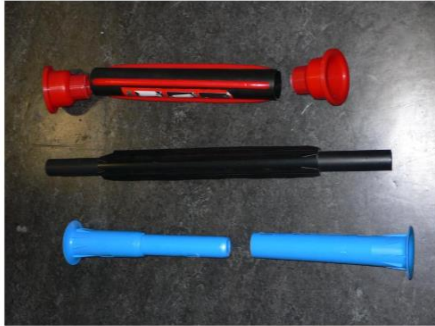
Figura 3. Ejemplo de las asas reutilizables para utilización de los rollos de filmina envolvente sin centro de cartón.
