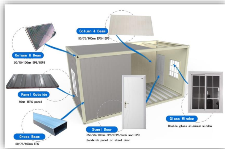
Figura 4. Partes de Contenedor plegable
