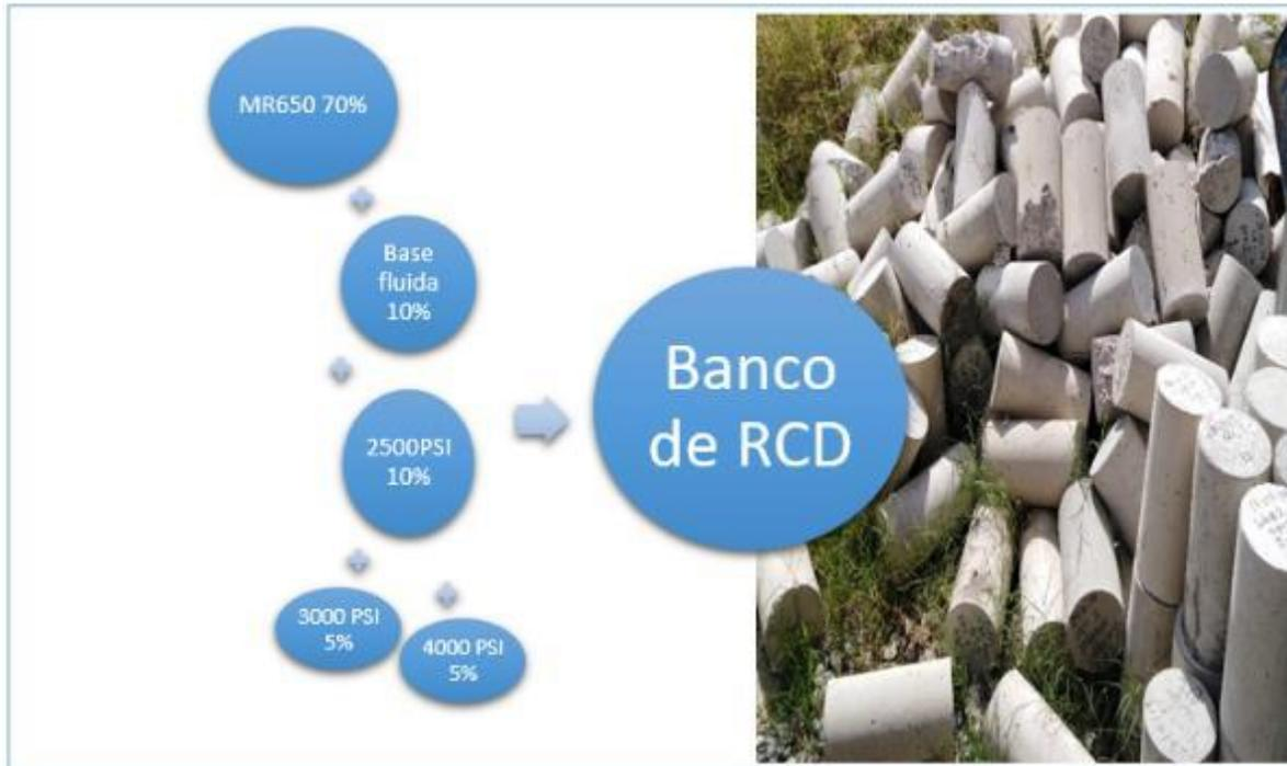
**Figura 18 Composición de material triturado para muestra**
