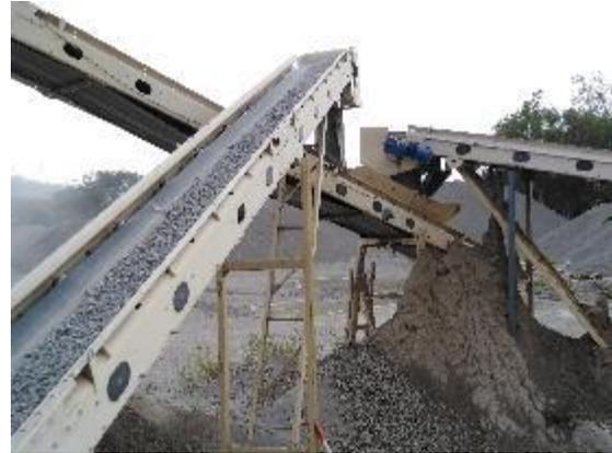
**Figura 23 Proceso de trituración del material de desechos de construcción y demolición.**
