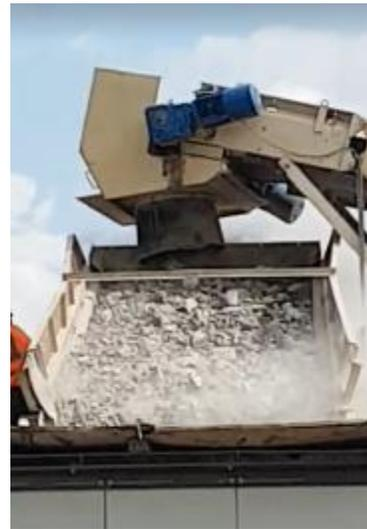
**Figura 22 Proceso de trituración del material de desechos de construcción y demolición.**
