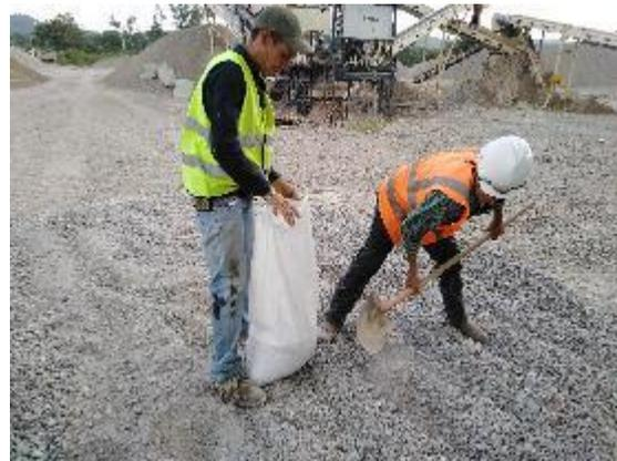
**Figura 26 Toma de muestra en el acopio del material triturado.**
