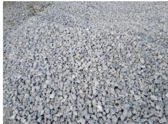
**Figura 24 Material resultante del proceso de trituración**
