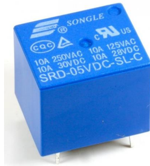
Ilustración 22. Relé 5V, 10A 125 VAC/280 VDC
