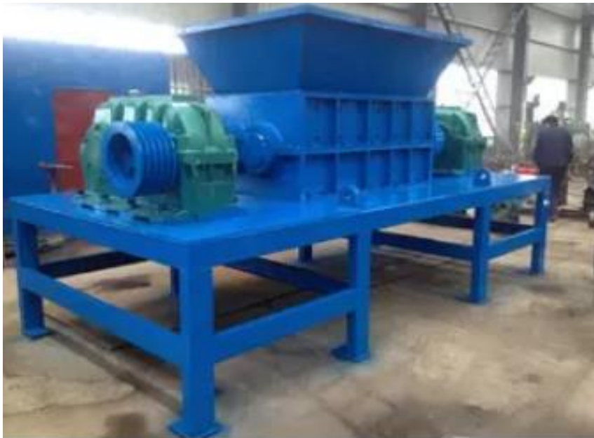
Figura 6.26 Máquina trituradora, tiene una capacidad hasta de triturar hasta de una tonelada de papel diaria según ficha técnica.
