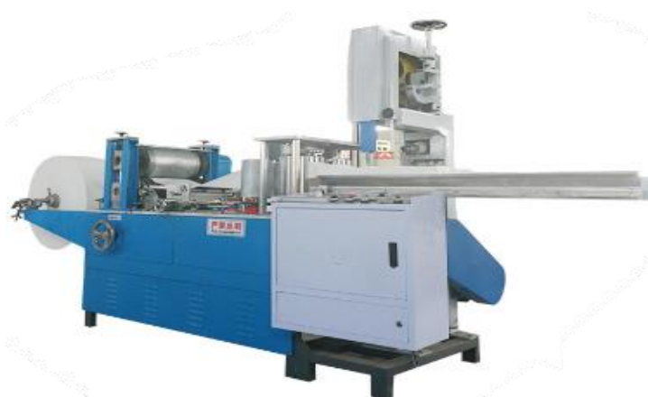
Figura 6.29 Máquina de transporte, secado y formado de papel, tiene una capacidad de una tonelada por día según ficha técnica.
