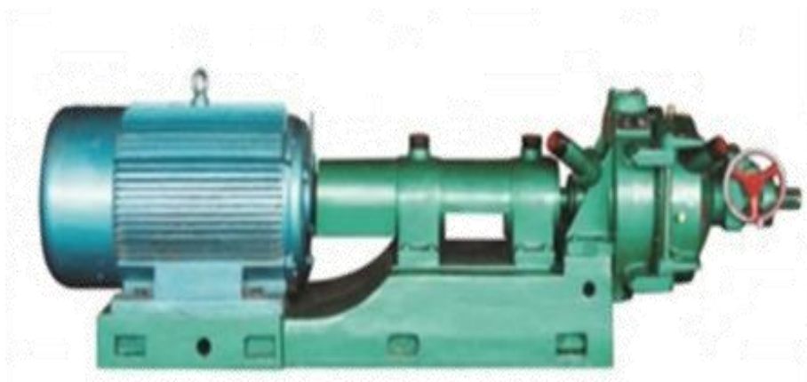
Figura 6.28 Máquina refinadora, tiene una capacidad de tres a cinco toneladas de papel al día según ficha técnica.
