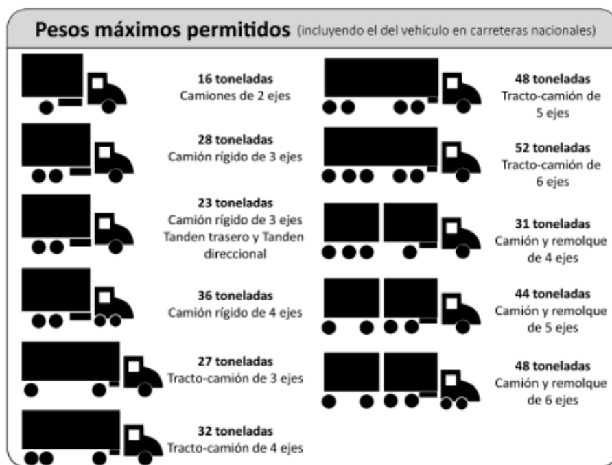
Ilustración 4.6 Tipos de camiones de carga según su función
