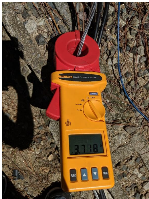
Ilustración 25: Medición de resistencia en aterrizaje
