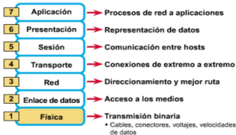
ilustración 13 Capas del modelo OSI Fuente: slideplay.com
