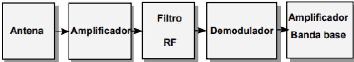
Ilustración 3-Diagrama de bloques del receptor
