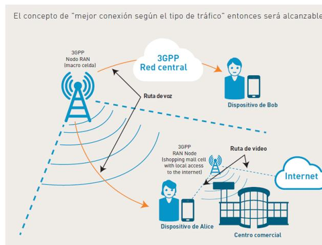
**Ilustración 9. "mejor conexión según tipo de tráfico"**
