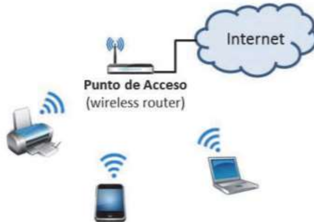
Ilustración 12- Esquema de una WLAN en el hogar
