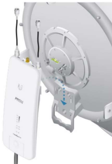
Ilustración 16-Incorporación del Rocket Prism 5AC Gen 2 en la antena Rocket Dish
