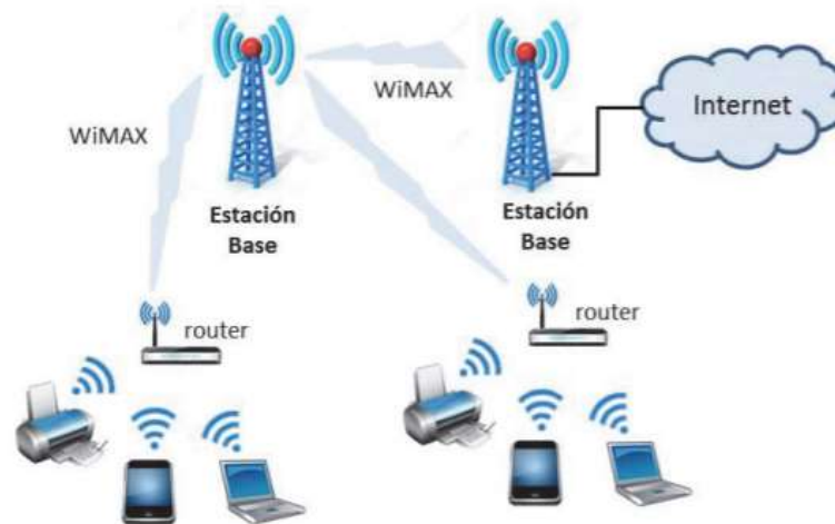
Ilustración 13- Diagrama de una red WiMAX
