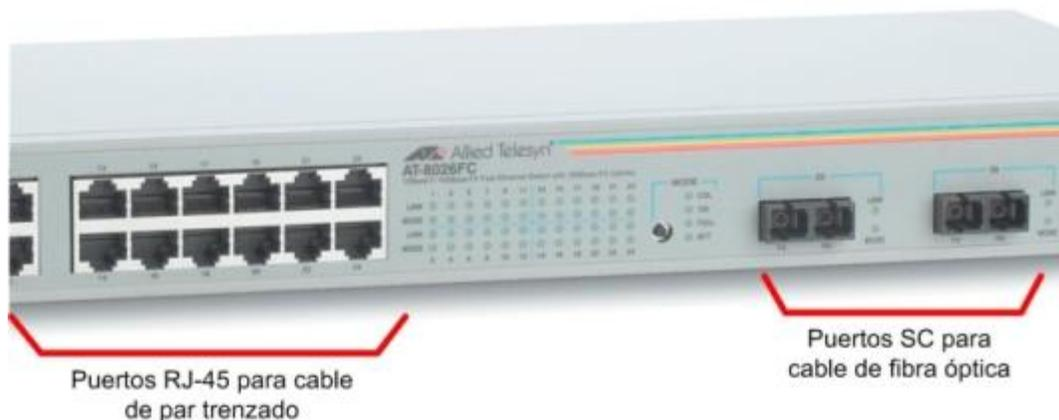
*Ilustración 11. Switch con puertos RJ-45 y SC*
