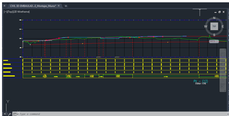
Ilustración 83. Montaje preliminar de perfiles de calle y muros de contención.
